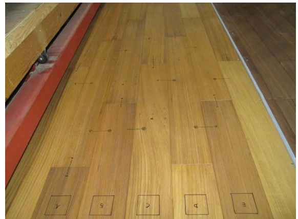
写真 10 試験終了時の状況 （チーク 20 クリアオイル）
