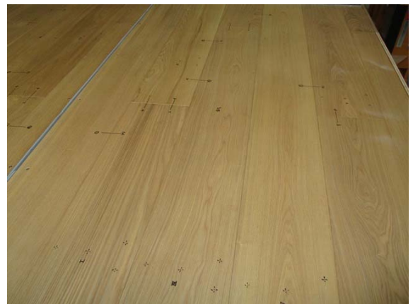
写真 7 試験終了時の状況 （アッシュ 20 クリアオイルロング）
