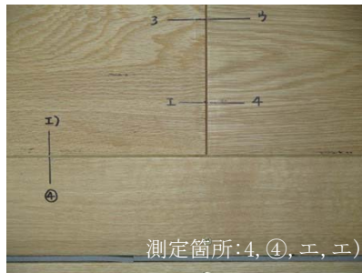
写真 2 試験終了時の状況（一般部）（オーク 40 クリアオイルロング）
