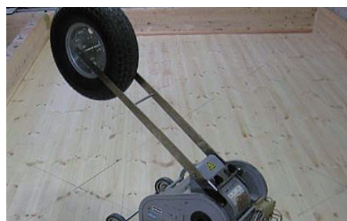
重量床衝撃音試験 (バグマシン)
